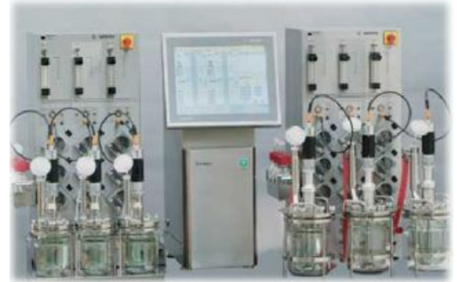
Şekil 2. 6'lı seri biyoreaktör sistemi
