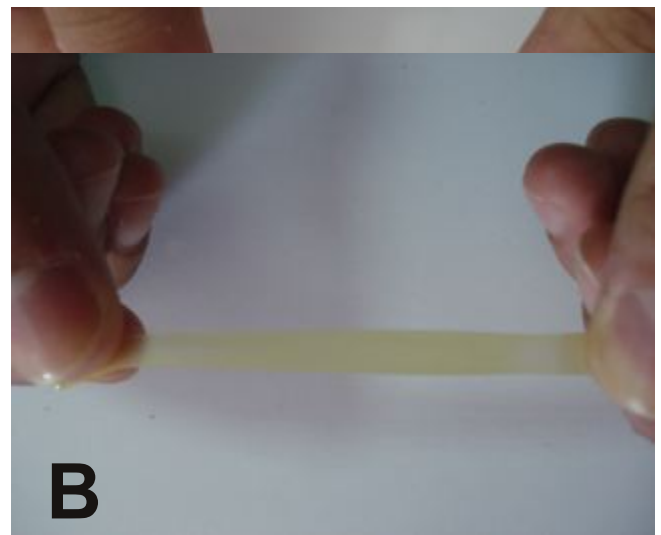
Şekil 1. Kırılgan zein filmlerden esnek ve kontrollü salım yapabilen aktif (antimikrobiyel ve antioksidant) zein filmler üretilmesi (A) Standart zein filmin iki ucundan çekilerek gerdirildiği zaman esneklik göstermeden camsı bir şekilde kopması; (B) Tarafımızdan üretilmiş esnek aktif zein filmin iki ucundan çekilerek gerdirildiği zaman %100'e yakın oranda esneyerek kopmadan uzaması
